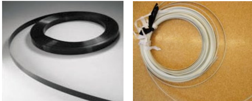
Abb. 2 | Herkömmliche Materialien zur Konstruktion von Reifröcken in der Bühnenkostümgestaltung. Links: Eine Rolle Federbandstahl, ca. 2,5cm Breite, rechts: Eine Rolle Endlos-Plastikstäbchen, ca. 1,2 cm Breite (Fotos: Dorothea Nicolai).
