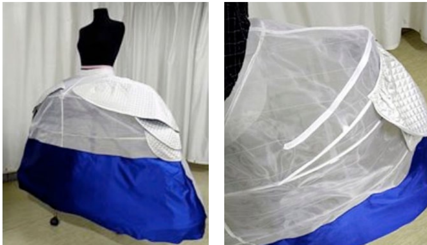
Abb. 5 | Neuer Unterrock mit Reifrock für die Oper Le Cid aus Kohlefaserstäben, Kostümwerkstatt der Oper Zürich (Fotos: Dorothea Nicolai).
