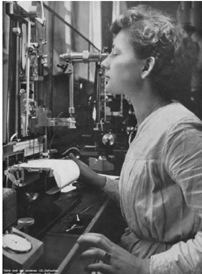
Abb. 14 | Zellwoll-Qualitätsprüfung (Abbildung aus: Vistra-Informationen , 10 [1940] 1, S. 41).
