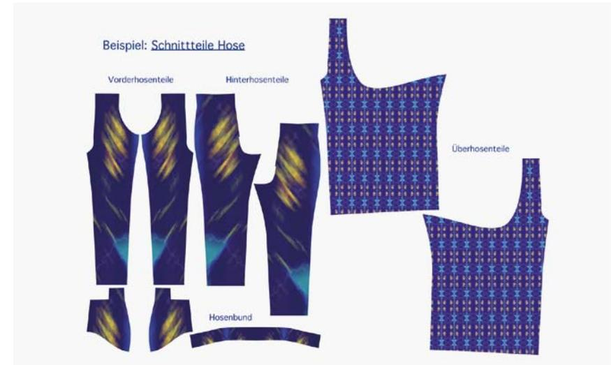
Abb. 4a | Schnittbild der Hose für den Digitaldruck, von links nach rechts: Vorderhosenteile, Hinterhosenteile und Hosenbund, Überhosenteile, Peter Schramm (Abbildung: HTW Berlin).
