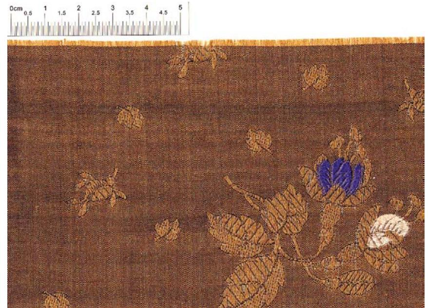
**Abb. 3** | Detail eines Kleiderstoffes mit vegetabilen Motiven, Jacquardgewebe, Schussbroché, mit Dezimal-Skalierung, Material: vermutlich in Kette Organsin, Grundschüsse Eisengarn<sup>3</sup>, Borchierschüsse (Weiß, Blau Seide, 48 Kettfäden pro 1 cm, 72 Schussfäden pro 1 cm, ohne Brochierschüsse, wohl handgewebt, Größe des Exponats: B.: 128 mm x H.: 107 mm, Entstehung: vermutlich um 1885, Hersteller: unbekannt, Sammlung: Prof. Wieland Poser, Halle/Saale (Foto: Wieland Poser).
